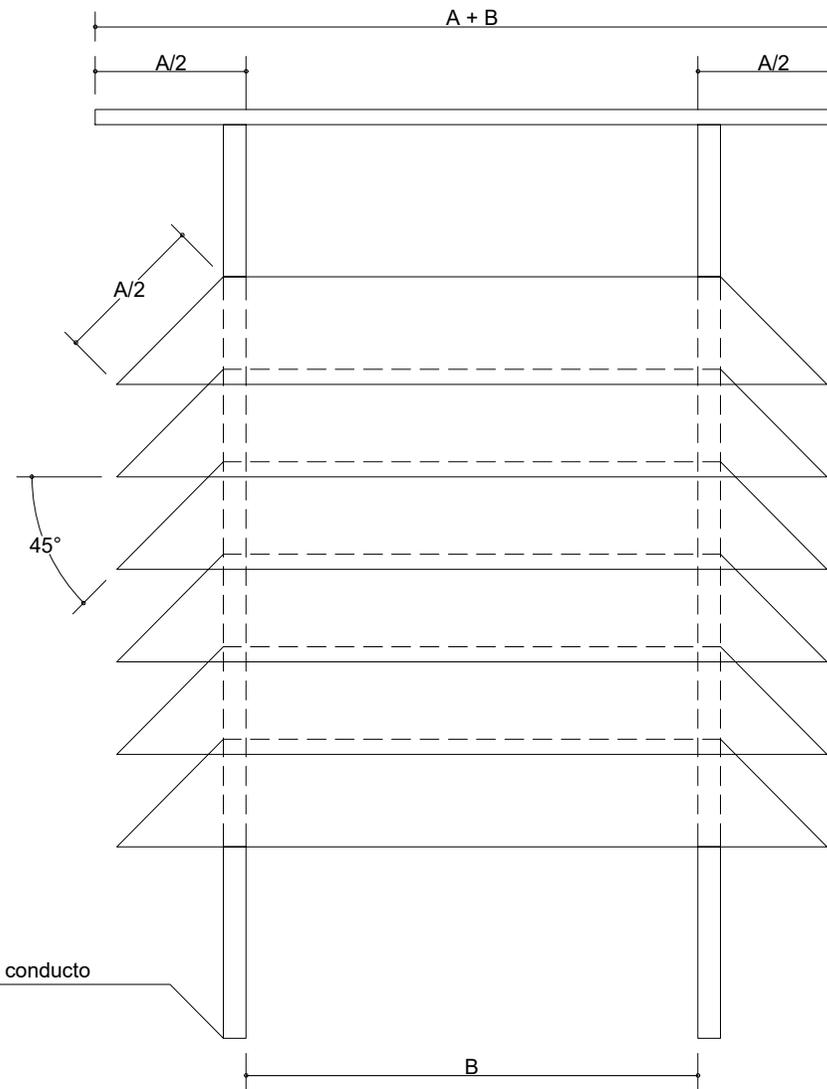
Nota: para el deflector tipo C, todas las medidas están dadas en función de las dimensiones interiores (A x B) de un conducto de sección rectangular. Si el conducto es de sección cuadrada, entonces A = B. Estas dimensiones deducidas deben tener una tolerancia de más o menos 10%.
